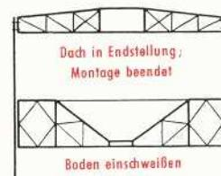
In der Endstellung wird das Dach endgültig am Mantel angeschlossen, nachdem die Bodeninnenfläche fertig geschweißt wurde. Die Scheibe wird abgefahren, der Behälter ist fertig zur Dichtheitsprobe.
