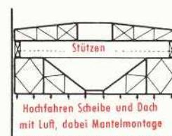
Die Scheibe mit aufgesetztem Dach wird mit Gebläseluft stufenweise hochgefahren, dabei Montage des Mantels, der Treppen und Umgänge. Die Scheibe dient hierbei mit den angehängten Rüstungen nicht nur als Montagepodium, sondern über ein System von Zwangsrollen gleichzeitig auch als Grundrißlehre.
