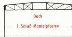
Die unteren Mantelposten mit den Verankerungen werden aufgestellt und durch mehrere Mantelblechschüsse fixiert. Die Dachkonstruktion wird montiert, die Dachbleche werden ausgelegt und geschweißt, desgleichen Entlüfter und Dachrandgeländer.
